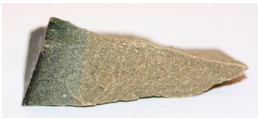
Figur 24-15. Ett prov från ett block i ABM-försöket vid Äspölaboratoriet, med en tydlig reaktionszon mellan järn och bentonit. Provet är ungefär 4 cm långt.
