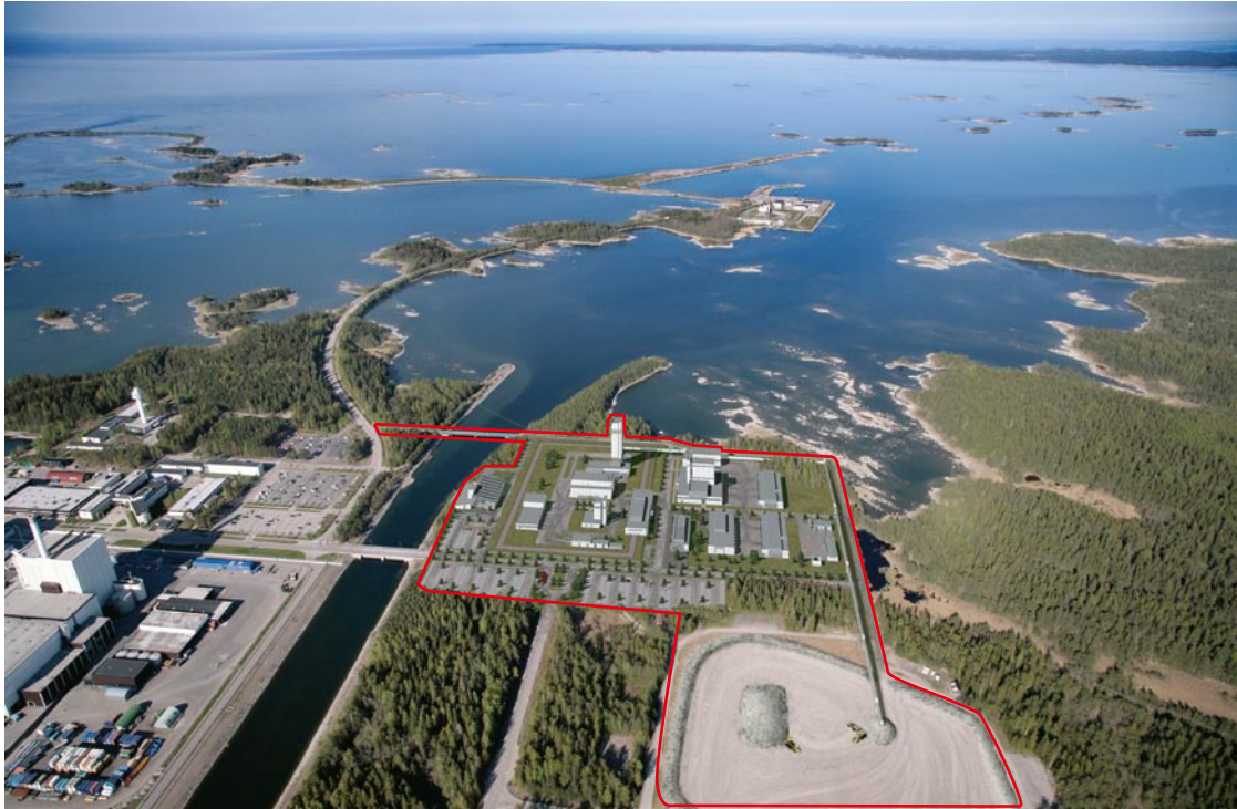
Figur 8-4. Bildmontage med de markförlagda delarna av den planerade slutförvarsanläggningen i Forsmark. De röda markeringarna visar driftområdet och upplag för bergmassor. Till vänster i bilden syns delar av kärnkraftverket.
