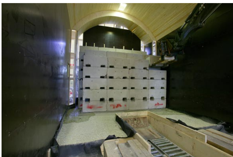
Figur 13-5. Staplingstester utförda vid Bentonitlaboratoriet på Äspö.
