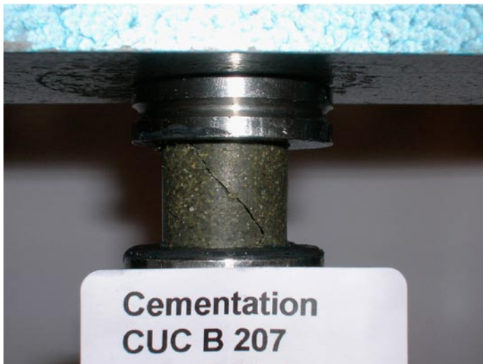
Figur 24-16. Exempel på ett enaxligt tryckförsök. Provet belastas med konstant deformationshastighet i axial-led till brott. Axial spänning och töjning mäts. Från /24-28/.
