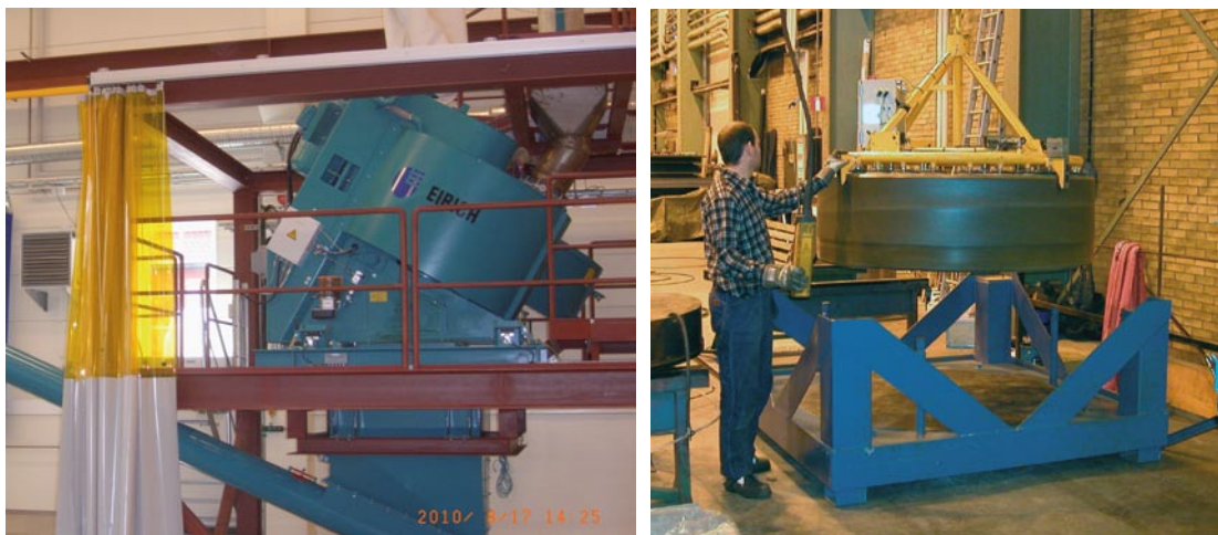
Figur 12-2. Till vänster: Blandare av typ Eirich som använts för konditionering av bentonit vid Äspö-laboratoriet. Till höger: Ett bentonitblock placeras på en transportpall.
