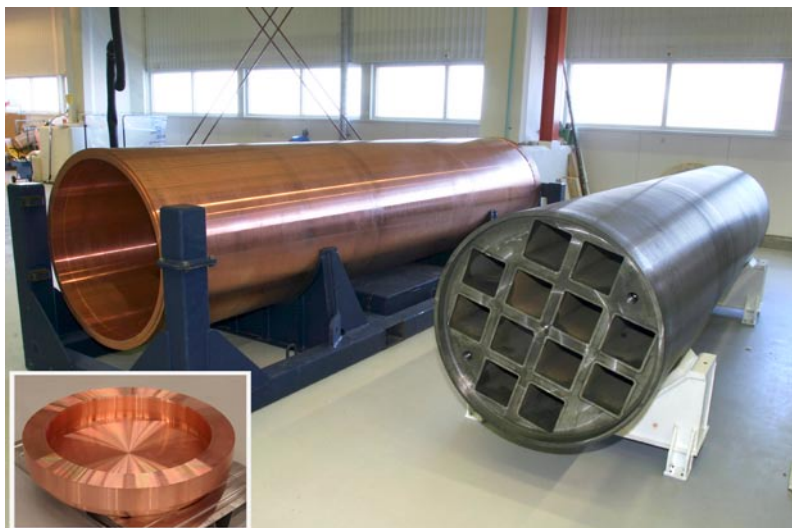
Figur 1-6. Kopparkapsel med insats av segjärn (det infällda fotot visar kopparlocket).
