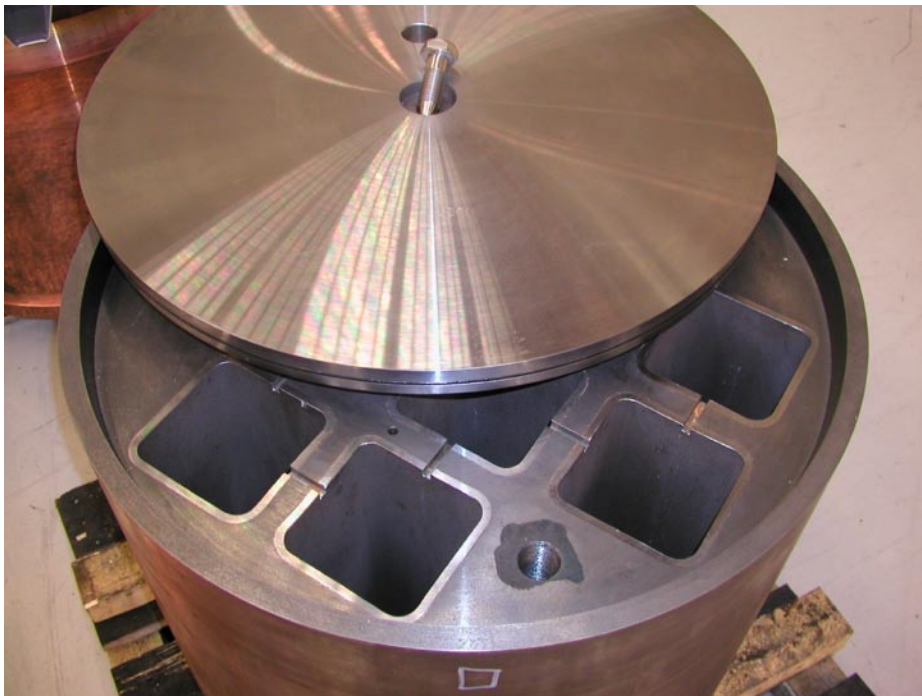
Figur 11-2. En del av en maskinbearbetad insats och ett ställock med hål för ventil för atmosfärsbyte samt en centrumskruv för montering i insatsen.
